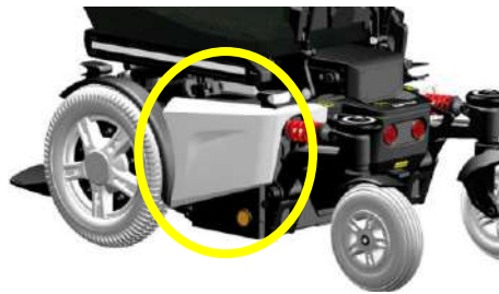
Figura 10-5: Caja de baterías
